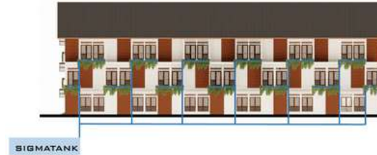
Gambar 6 Pipa penyiraman tanaman melalui sigmatank sumber : dokumentasi pribadi
