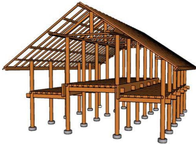
Gambar 4: Sistem Struktur Rumah Aceh
