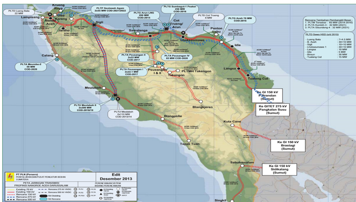
Gambar 1. Peta Sistem Kelistrikan & Kapasitas Pembangkit Eksisting Provinsi Aceh
